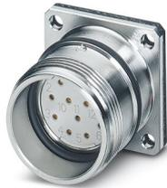
M23, Embases paroi avant, série: RC, droit, blindé: oui, Verrouillage à vis, Nombre de pôles: 17, Sens de rotation: standard, type de contact: Connecteur femelle, Raccordement soudé, Joint plat, 4x Ø2,7, détrompage: Y, Produit de remplacement selon RoHS II sans exception 6c (Pb < 0,1 %) référence : 1242573
