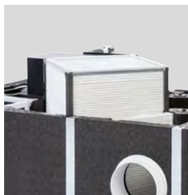
Echangeur ST, Haut Rendement à flux croisé Fabriqué avec de plaques de polypropylène.
