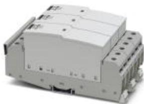
Parafoudre enfichable, selon type 1/classe I, avec fusible intégré résistant aux courants de choc, pour réseaux électriques triphasés avec PE et N combinés dans un conducteur (L1, L2, L3, PEN).
