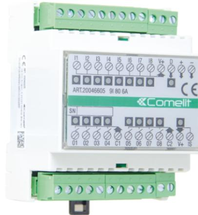
Module SimpleHome avec 9 entrées (8 + 1scénario) pour relier les boutons au tableau électrique et de 8 sorties à relais avec contact NO (1 commun pour 4 sorties) pour commander des charges électriques de type résistif 6A. Ne convient pas pour la commande de lampes fluorescentes, à leds, à basse consommation ou de fortes charges. Dimensions : 71x90x58 mm (4 modules DIN).
