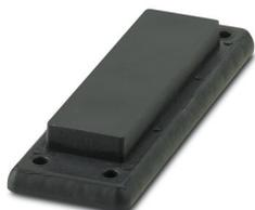
Plaques passe-câble, nombre de conducteurs: 10, diamètre extérieur du câble: 6x 2 mm ... 8 mm, 2x 2 mm ... 18 mm, 2x 2 mm ... 30 mm, matériau: PP (matériel intérieur), matériau: TPE-SEBS (matériel extérieur), coloris: noir, longueur: 154 mm, largeur: 56 mm, hauteur: 20 mm
