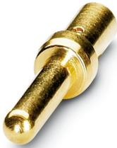
Contact à sertir, Mâle, tournés, Contact unique, diamètre de contact: 1 mm, zone de sertissage: 0,5 mm<sup>2</sup> ... 1 mm<sup>2</sup>, Produit de remplacement selon RoHS II sans exception 6c (Pb < 0,1 %) référence : 1241571
