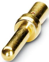
Contact à sertir, Mâle, tournés, diamètre de contact: 2 mm, zone de sertissage: 1,5 mm<sup>2</sup> ... 2,5 mm<sup>2</sup>, Produit de remplacement selon RoHS II sans exception 6c (Pb < 0,1 %) référence : 1241634
