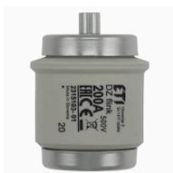
**Cartouche fusible, Basse tension, 200 A, AC 500 V, 50 kA, D5, 56 x 46 mm, gR, DIN, IEC, à action rapide**
