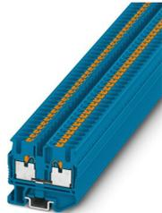
Bloc de jonction miniature, tension nominale: 500 V, intensité nominale: 24 A, nombre de connexions: 2, nombre de pôles: 1, type de raccordement: Raccordement Push-in, 1er étage, Section de référence: 2,5 mm<sup>2</sup>, section : 0,14 mm<sup>2</sup> - 4 mm<sup>2</sup>, type de montage: NS 15, coloris: bleu
