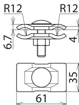
Pour la connexion de deux conducteurs parallèles avec une vis.
