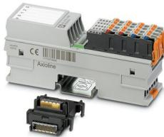
Axioline F, Module de détermination de la température, Entrées analogiques: 4 (pour capteurs de température résistifs), connectique: A 2, 3 ou 4 fils (blindés), vitesse de transmission dans le bus local: 100 MBit/s, Modèle pour conditions extrêmes, indice de protection: IP20, incl. module d'embase de bus et connecteurs Axioline F
