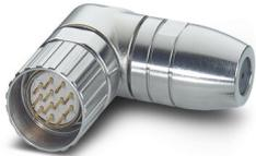
M23, Connecteurs à câble, série: RC, coudé, blindé: oui, Verrouillage à vis, Nombre de pôles: 17, Sens de rotation: standard, type de contact: Mâle, Raccordement à sertir, plage de diamètre de câble: 3 mm ... 10,5 mm, détrompage: N, Produit de remplacement selon RoHS II sans exception 6c (Pb < 0,1 %) référence : 1242566
