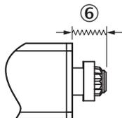
⑥ Plage de déplacement du capuchon à suspension (jusqu'à 5 mm de compression à l'état non monté)
