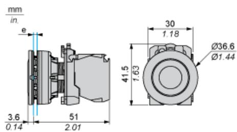
e : Epaisseur du dispositif de serrage : 1 à 6 mm / 0,04 à 0,24 po.
