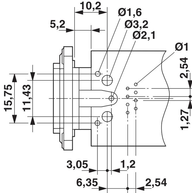
Gabarit de perçage pour VS-08-BU-RJ45-6/LH-1
