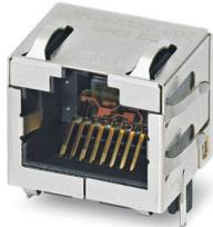
Connecteurs pour circuits imprimés RJ45, type: RJ45, indice de protection: IP20, nombre de pôles: 8, 10 Gbit/s, matériau: Plastique, type de raccordement: À la vague THT, sortie du câble: droit
