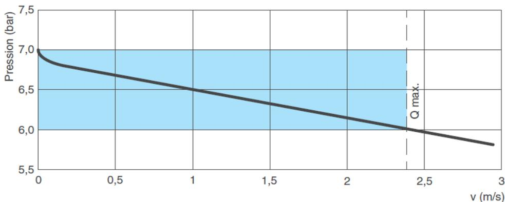
La figure montre la chute de pression dans la vanne quand le débit augmente. S'assurer que les conditions de fonctionnement se positionnent dans la zone en bleue en fonction de la vitesse d'écoulement recommandée pour la vanne.
