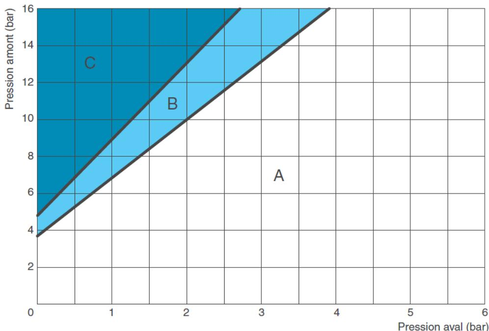
Le phénomène de cavitation peut provoquer des dommages substantiels en plus des vibrations et du bruit. Le diagramme de cavitation est utilisé pour déterminer si le point de fonctionnement obtenu par l'intersection des amont (axe des y) et la pression aval (axe des x) correspond à une des 3 zones ci-après :
