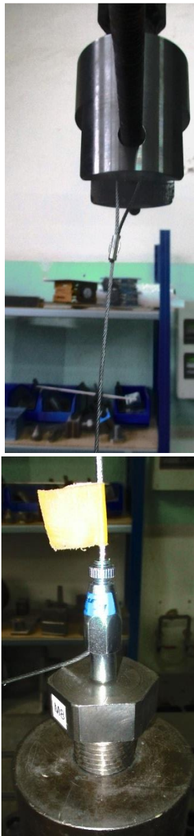
Figure 1: Schéma du dispositif d'essais de traction d'un élément de suspension
