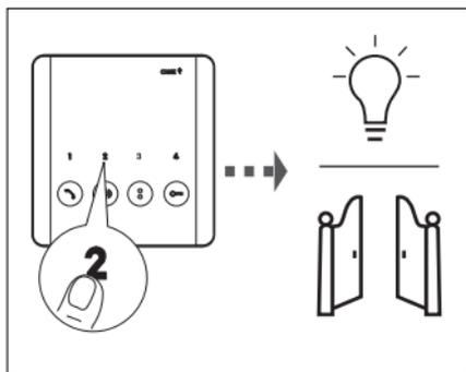
Appuyer sur le bouton AUX pour activer la commande auxiliaire souhaitée.
