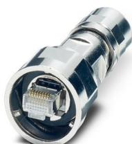
Connecteur RJ45, type: RJ45, indice de protection: IP67, nombre de pôles: 8, 1 Gbit/s, CAT5 (CEI 11801:2002), matériau: Métal, type de raccordement: Raccordement autodénudant IDC, section raccordable: AWG 27- 24, sortie du câble: droit, coloris: argent
