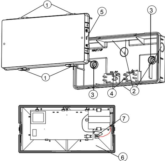
**Note : Le câblage du bloc autonome doit être réalisé en fil rigide 1,5 mm<sup>2</sup>.**
