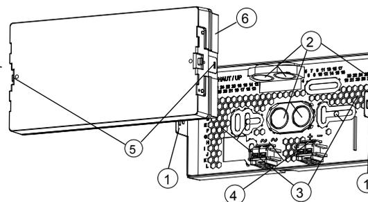
**Note : Le câblage du bloc autonome doit être réalisé en fil rigide 1,5 mm<sup>2</sup>.**
