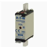
**Cartouche fusible, Basse tension, 16 A, AC 400 V, 120 kA, NH000, gFF, IEC, à double indicateur de fusion, pattes d'extraction isolées**
