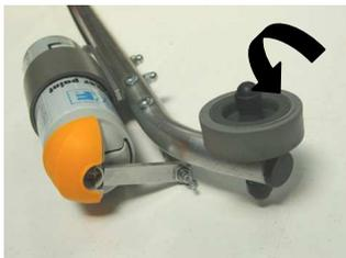
Repositionner la pièce d'appui sur le diffuseur de l'aérosol. Cette opération se fait en tournant le capot et la pièce de l'aérosol. Cette opération se fait en tournant le capot et la pièce d'appui de façon à ce que cette dernière se place correctement sur le diffuseur, bien au milieu. La canne est alors prête à fonctionner.
