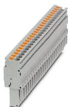
Connecteurs, tension nominale: 500 V, intensité nominale: 24 A, nombre de connexions: 24, nombre de pôles: 24, type de raccordement: Raccordement Push-in, 1er étage, Section de référence: 2,5 mm<sup>2</sup>, section : 0,14 mm<sup>2</sup> - 4 mm<sup>2</sup>, coloris: gris
