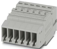
Couplage COMBI, tension nominale: 500 V, intensité nominale: 24 A, nombre de connexions: 6, nombre de pôles: 6, type de raccordement: Raccordement Push-in, 1er étage, Section de référence: 2,5 mm<sup>2</sup>, section : 0,14 mm<sup>2</sup> - 4 mm<sup>2</sup>, coloris: gris
