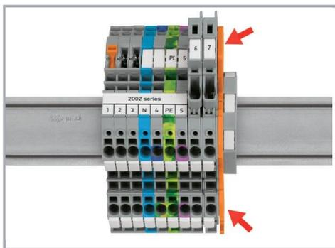
L'utilisation d'une plaque d'extrémité pour borne à fusible est nécessaire (par ex. 2002-1092, orange) en fin de montage ou s'il n'y a pas de borne à fusible adjacente.
