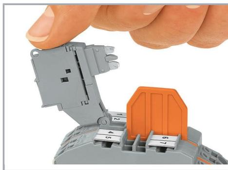
La borne à fusible à deux étages avec porte-fusible pivotant (2002-2611, gris) est combinable avec les bornes sectionnables, de passage et de protection. Le porte-fusible est aussi disponible avec témoin de fusion à LED (par ex. 2002-2611/1000-541 pour 12 ... 30 V).
