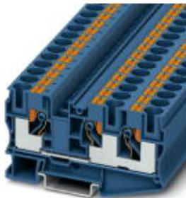
Blocs de jonction simple, type de raccordement: Raccordement Push-in, nombre de connexions: 3, section :0,5 mm<sup>2</sup> - 16 mm<sup>2</sup>, AWG: 20 - 6, largeur: 10,2 mm, hauteur: 49,5 mm, coloris: bleu, type de montage: NS 35/7,5, NS 35/15
