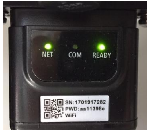
Figure 52 - État de communication irrégulière entre onduleur et carte
