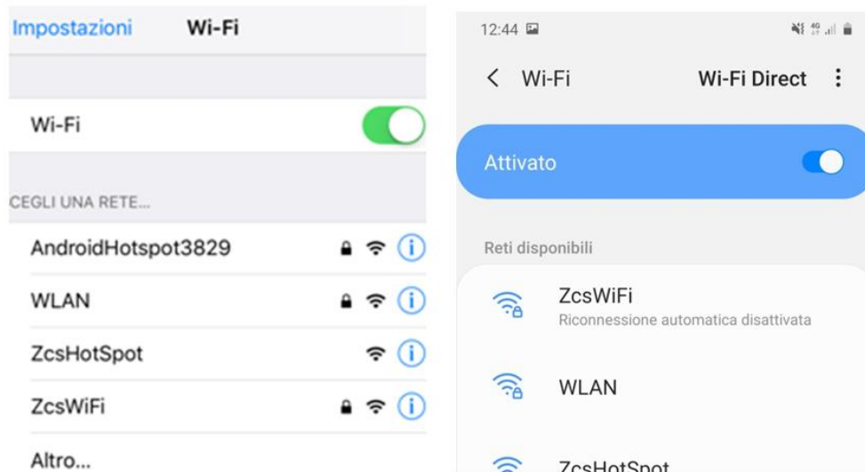
Figure 36 – Recherche des réseaux Wi-Fi sur Smartphone (iOS et Android) ; le Point d'accès de la carte Wi-Fi n'est plus visible
