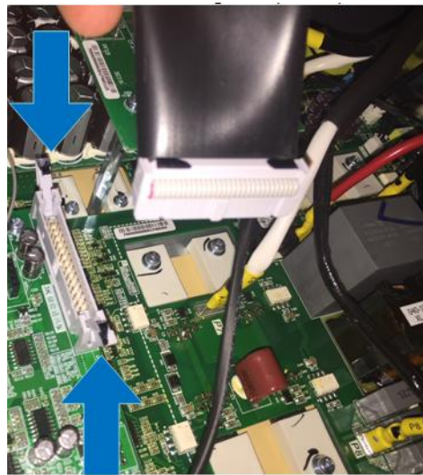
Figure 2 – Ouverture des crochets présents sur le logement du connecteur plat
