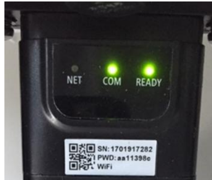
Figure 59 – État de communication irrégulière entre carte et serveur à distance
