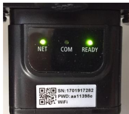
Figure 58 – État de communication irrégulière entre onduleur et carte
