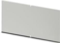
Paroi latérale à utiliser avec les demi-coques de boîtiers dans les dimensions 195 x 145 mm et 145 x 125 mm ; épaisseur de paroi : 2 mm ; hauteur totale du boîtier : 67 mm ; matériau : polycarbonate ; couleur gris clair similaire à RAL 7035
