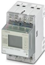
CHARX control modular, compteur d'énergie triphasé pour la détermination par mesure directe de la puissance active dans des réseaux pouvant atteindre 400 V / 40 A, avec interface RS-485, certifié selon la directive MID
