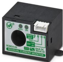
CHARX control modular, le module de surveillance du courant différentiel sert à détecter le courant de défaut AC et DC sur les bornes de recharge à courant alternatif. Le dispositif de protection superposé (p. ex. disjoncteur différentiel) est protégé contre les courants de défaut DC éventuels.
