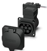
CHARX connect modular, Prise côté infrastructure, Rectangulaire, Basic, Kit, avec capot de protection carré, pour la charge en courant alternatif (AC) des véhicules électriques (VE), Type 2, CEI 62196-2, 32 A / 480 V (AC), sans fils individuels, actionneur de verrouillage: 12 V, 3 pôles, Montage sur la paroi arrière, Filetage M5, boîtiers: noir, Logo PHOENIX CONTACT
