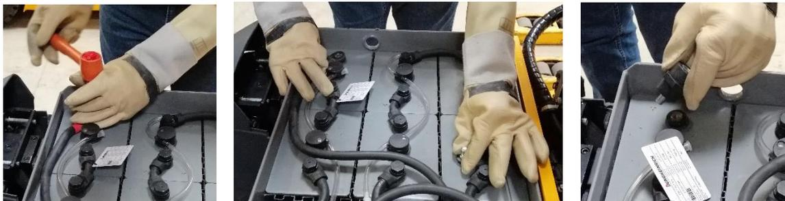
Dévisser le second pôle de la batterie et placer l'étrier\* comprenant le deuxième plot isolant.
