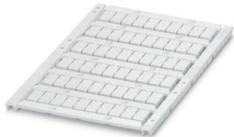
Repères pour blocs de jonction, à commander : sous forme de planche, blanc, impression selon les indications du client, type de montage: encliquetage dans la rainure de repérage élevée, pour bloc de jonction au pas de : 6,2 mm, surface utile: 5,6 x 10,5 mm, Nombre d'étiquettes: 60
