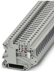
Bloc de jonction à fonction, L'intensité et la tension sont fonction de la fiche utilisée., tension nominale: 500 V, intensité nominale: 20 A, type de raccordement: Raccordement vissé, Section de référence: 4 mm<sup>2</sup>, section : 0,14 mm<sup>2</sup> - 6 mm<sup>2</sup>, montage: NS 35/7,5, NS 35/15, coloris: gris
