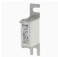
**Cartouche fusible, grande vitesse, 20 A, AC 690 V, 200 kA, DIN 000, 21 x 40 x 100 mm, gR, DIN, IEC, indicateur de type T**
