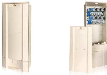
**Ensemble de coupure 400A ou protection 200 A à 2 directions permettant l'alimentation d'un ensemble collectif ou un branchement individuel à forte puissance.**
