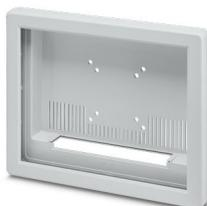
Boîtier d'affichage 15", gris clair, fenêtre au milieu, façade plate avec fentes d'aération, avec une découpe pour la tôle angulaire de raccordement et un montage VESA, composé de deux demi-coques et de vis
