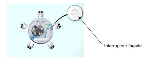
L'interrupteur et le bandeau lumineux s'allument, le ventilateur s'enclenche. Au démarrage le bandeau lumineux est rouge pendant un instant, tant que la lampe UV n'est pas allumée, puis il devient bleu quand la lampe s'allume. Si la durée de fonctionnement de la lampe a dépassé 8 280 heures, le bandeau lumineux reste rouge indiquant qu'il faut commander une lampe de rechange.
