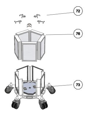
Mettre les filtres neufs en place, puis les clips (N°72) en fixant d'abord les crochets dans les trous du cadre porte filtre puis en plaquant le clip sur le haut du filtre et tourner la bride des filtres (N°73) d'1/8è de tour dans le sens des aiguilles d'une montre.
