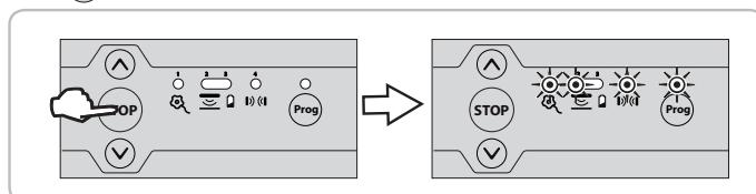
Wenn der Ferienmodus aktiviert ist, blinken bei jedem Druck auf einen verriegelten Funksender (Programmierschnittstelle oder Fernbedienung) die Leuchten 1, 2, 4 und Prog 2 Sekunden lang.
