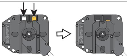
**Nota :** Les fins de course moteur peuvent également être réglés avec un câble de réglage (ref. 9015971). Dans ce cas, régler les fins de course avec le câble puis passer à l'étape [8] pour sortir du mode réglage moteur.
