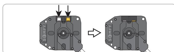
Nota : i finecorsa del motore possono anche essere regolati con un cavo di regolazione (cod. 9015971). In questo caso, regolare i finecorsa con il cavo, poi passare alla fase [8] per uscire dalla modalità di regolazione del motore.
