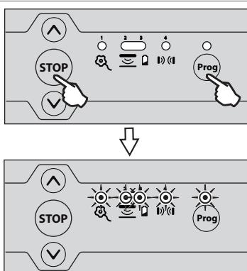
Zur Entsperrung der Programmertasten wiederholen Sie den oben beschriebenen Vorgang.
