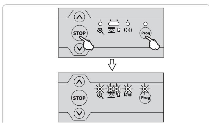
Pour déverrouiller les touches de programmation, répéter la procédure de verrouillage décrite ci-dessus.
