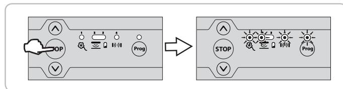
Als de vakantiemodus is ingeschakeld, gaan bij elk druk op de vergrendelde bediening (programmeringsinterface of afstandsbediening) de leds 1, 2, 4 en Prog gedurende 2 seconden knipperen.
