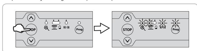
Lorsque le mode vacances est activé, chaque appui effectué sur une commande verrouillée (interface de programmation ou télécommande) provoque le clignotement des voyants 1, 2, 4 et Prog pendant 2 secondes.
