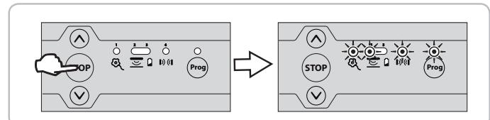
Quando la modalità vacanze è attivata, ogni pressione esercitata su un comando bloccato (interfaccia di programmazione o trasmettitore) provoca un lampeggiamento dei LED 1, 2, 4 e Prog per 2 secondi.
