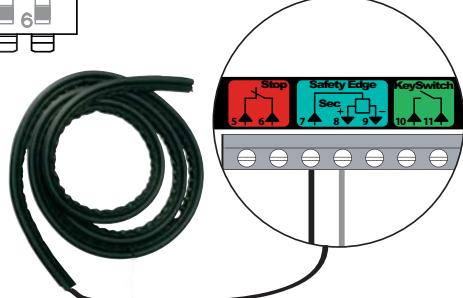
**⚠ Si une barre palpeuse filaire remplace une barre palpeuse radio, l'émetteur barre palpeuse radio doit être effacé (voir partie 12) afin que la barre palpeuse filaire soit prise en compte.**
