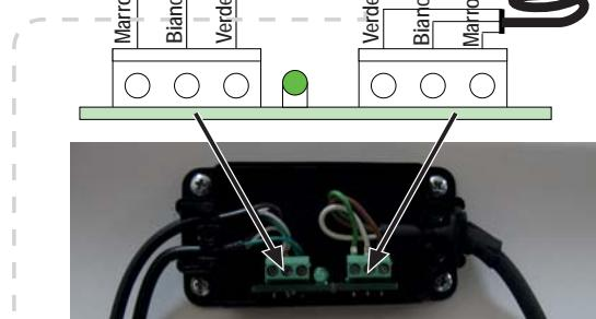
Se una costa di sicurezza filare sostituisce una costa di sicurezza radio, il trasmettitore costa di sicurezza radio deve essere cancellato (vedere sez. 12) per fare in modo che la costa di sicurezza filare venga presa in considerazione.
