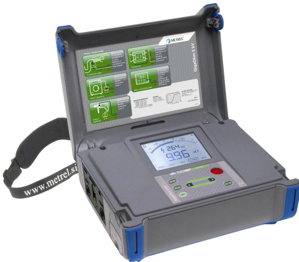
**Mesureur d'isolement 5kV**
