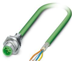
Connecteur d'appareil face arrière, PROFINET CAT5 (CEI 11801:2002), 4-pôles, PVC/PVC, vert RAL 6018, Connecteur mâle, droit, M12, détrompage: D, sur extrémité libre, Montage face arrière, M16 x 1,5, Ligne de bus, longueur de câble: 5 m, PROFINET, Produit de remplacement selon RoHS II sans exception 6c (Pb < 0,1 %) référence : 1240019
