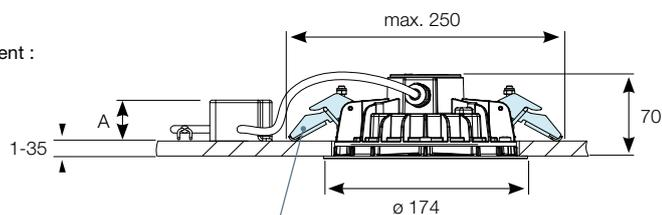
Fixations anti-arrachement avec fermeture par vis antivandales
