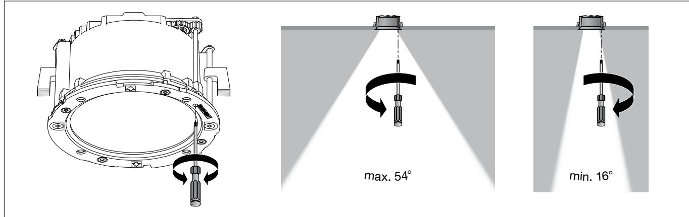
Über die Stellschraube (Torxantrieb T15) im Gehäuserand kann der Halbstreuwinkel der optischen Linseneinheit zwischen 16° und 54° stufenlos eingestellt werden.
