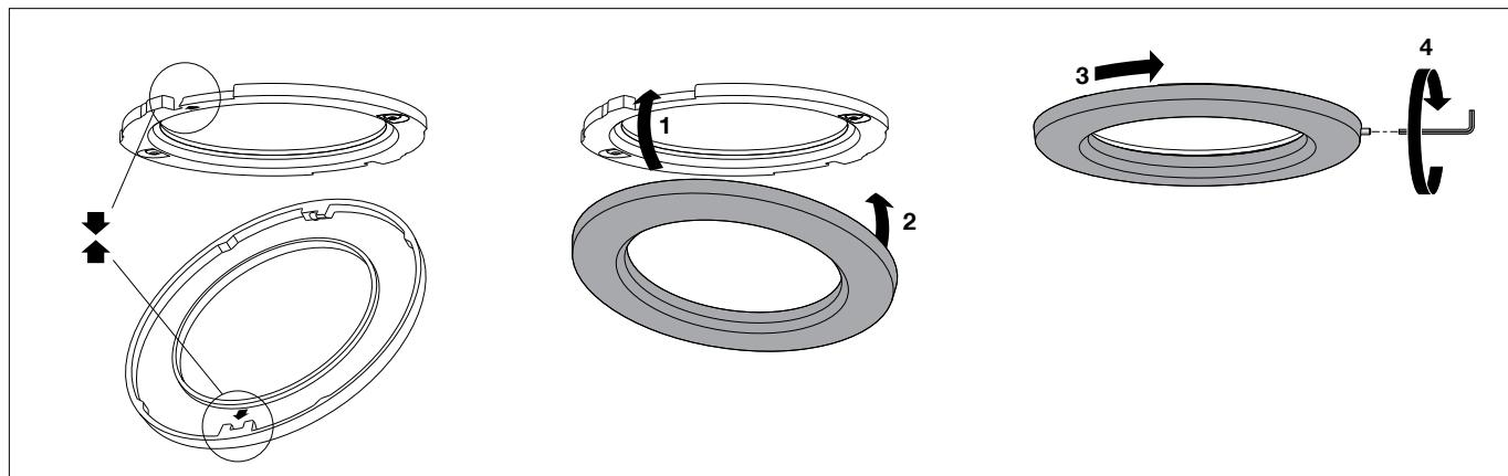
Beiliegenden Abschlussring (wie in der Skizze dargestellt) aufsetzen und rechts herum drehen.
