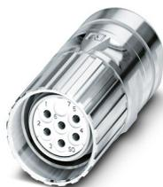
M23, Connecteurs à câble, série: CA, droit, blindé: oui, Verrouillage à vis, Nombre de pôles: 7, Sens de rotation: standard, type de contact: Connecteur femelle, Raccordement à sertir, plage de diamètre de câble: 10 mm ... 14,5 mm, détrompage: N, Produit de remplacement selon RoHS II sans exception 6c (Pb < 0,1 %) référence : 1243742
