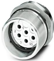
M23, Embases paroi avant, série: CA, droit, blindé: oui, Pour verrouillage standard et SPEEDCON, Nombre de pôles: 6, Sens de rotation: standard, type de contact: Connecteur femelle, Raccordement soudé, Joint axial, Fixation centrale Pg13,5, détrompage: N, Produit de remplacement selon RoHS II sans exception 6c (Pb < 0,1 %) référence : 1243882
