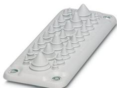
Plaques passe-câble, nombre de conducteurs: 27, diamètre extérieur du câble: 4x 5 mm ... 7 mm, 4x 8 mm ... 12 mm, 13x 10 mm ... 14 mm, 4x 14 mm ... 20 mm, 2x 20 mm ... 26 mm, matériau: Tôle d'acier galvanisé (matériel intérieur), matériau: TPE-SEBS (matériel extérieur), coloris: gris clair, longueur: 222 mm, largeur: 92 mm, hauteur: 29,5 mm
