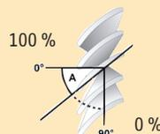
Ce paramètre permet de définir la position « Lamelles » pour la position intermédiaire 1. La valeur indiquée en pourcentage se réfère à l'inclinaison complète des lamelles pour le Store Vénitien correspondante paramétrée dans les fiches moteur 1...4 ou dans la fiche moteur 1-4.
