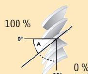
Ce paramètre permet de définir la position « Lamelles » pour la position intermédiaire 2. La valeur indiquée en pourcentage se réfère à l'inclinaison complète des lamelles pour le Store Vénitien correspondante paramétrée dans les fiches moteur 1...4 ou dans la fiche moteur 1-4.
