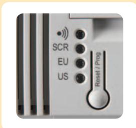
⚠ La diode « US » clignote régulièrement une fois que l'appareil est raccordé au réseau électrique (230 V) et au bus EIB, et ceux-ci mis sous tension. L'appareil est prêt à fonctionner quand la diode « US » clignote.
