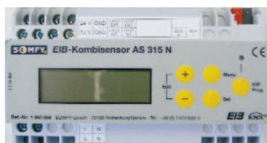
Pour le réglage d'un minuteur, le pilote de façade AS 315 N (Réf 1860069) peut être l'outil idéal.
