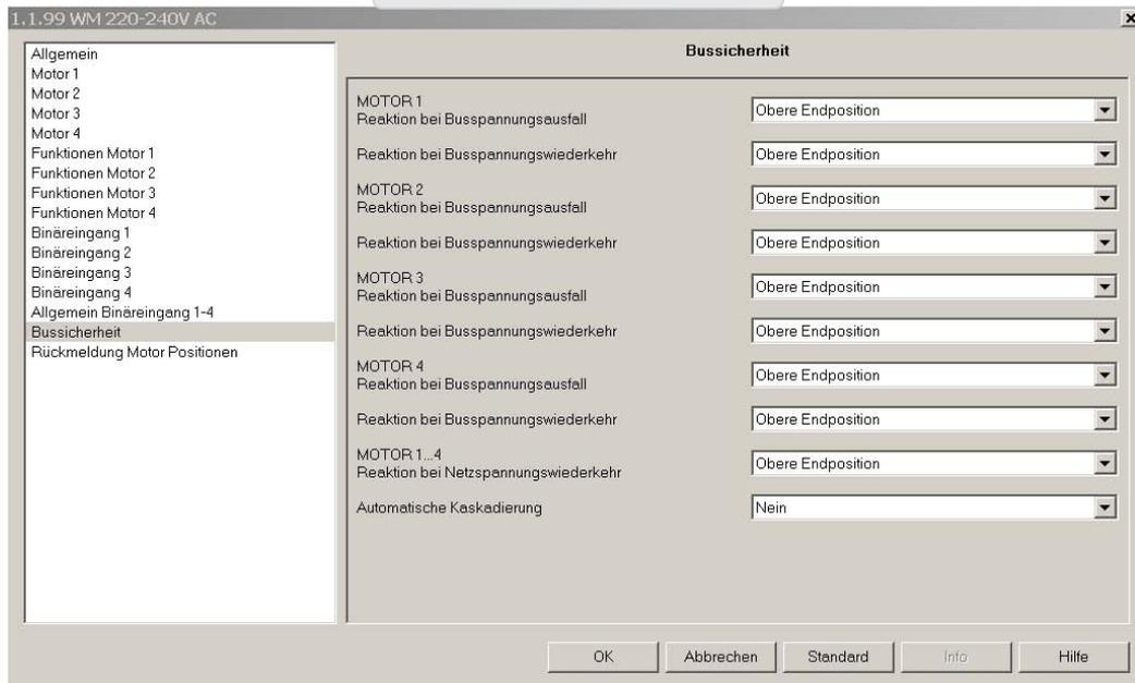
Cette fiche permet de définir, pour chacune des sorties moteur, la réaction en cas de coupure d'alimentation du bus et au rétablissement de cette alimentation.
