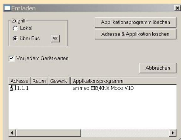
Si l'appareil a été programmé avec le logiciel ETS, un retour aux réglages d'usine par la touche Reset / Prog n'est plus possible. Pour réinitialiser l'ensemble des commandes de l'appareil, il faut utiliser la fonction « vider la mémoire » (*Entladen*) dans l'ETS, ce qui permet d'utiliser à nouveau la touche Reset / Prog.
