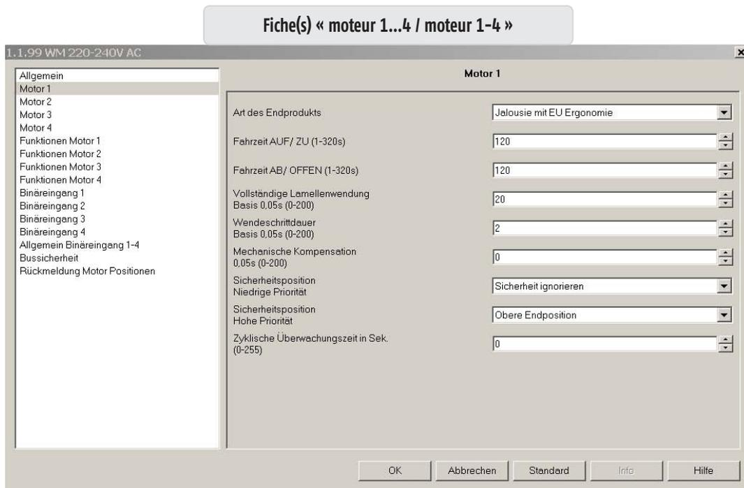
Quatre fiches distinctes (moteur 1...4) sont visibles quand la fiche « Généralités » du réglage de base des moteurs est paramétrée sur « Un par un ». Une seule fiche (moteur 1-4) est visible quand la fiche « Généralités » du réglage de base des moteurs est paramétrée sur « Groupé ».
