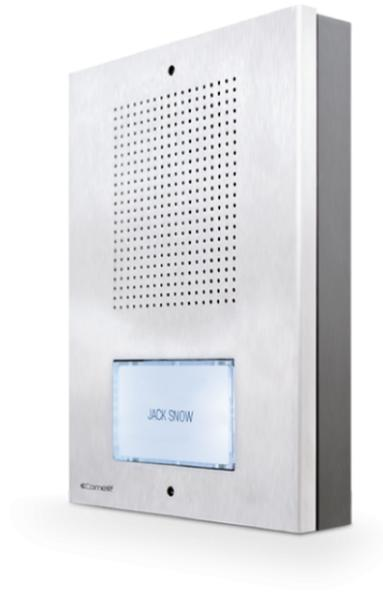
Platine extérieure audio série Extra avec 1 bouton d'appel. Enjoliveur en acier inox et rétroéclairage de l'étiquette porte-noms de couleur bleu. Elle est équipée d'un boîtier à encastrer et d'un support pour montage en saillie. Dimensions 95 x 135 x 6,5 mm (encastré) - 25 mm (en saillie). Câblage 5 fils.
