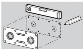
2 - Percer la plaque de plâtre avec une scie cloche (Ø 50 mm). Percer 8 trous (diamètre 7 mm) et enfoncer les chevilles à expansion directement sous la platine.
