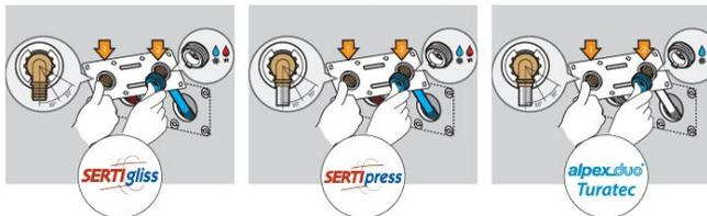
6 - Fixer la plaque sur le mur et poser les bouchons de protection.
