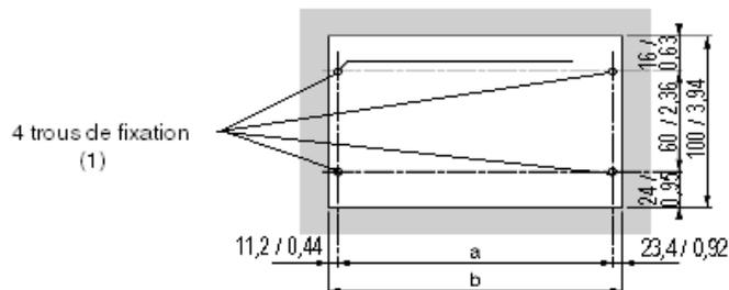
(1) Le diamètre des trous de fixation doit permettre l'utilisation de vis M4, M5, M6 et UNC n° 6.
