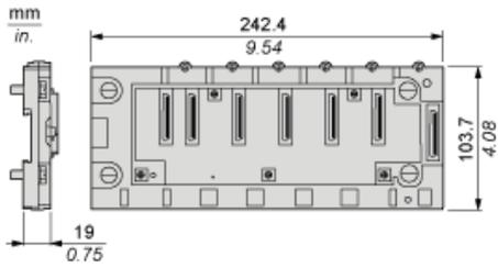
Installation d'un rack dans une armoire
