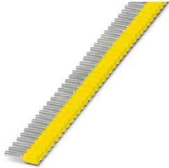
Embout en bande, 1,0 mm<sup>2</sup>, longueur d'embout 8 mm, avec collets en plastique, selon DIN 46228-4, coloris spécial jaune, avec extrémité fonctionnelle pour un traitement sûr et convivial avec Crimphandy, 20 bandes de 50 embouts chacune.
