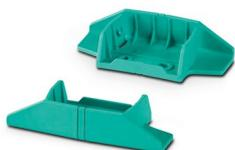
Socle pour la mise en place du boîtier UCS, hauteur : 47 mm, matériau : polyamide, couleur : bleu turquoise, similaire à RAL 5018, possibilité de fixation murale intégrée, encliqueté dans les trous de vis du boîtier
