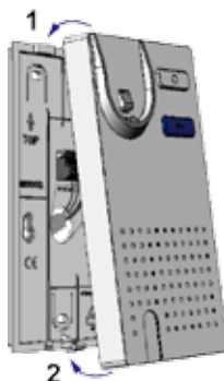
Obr. 7: Montáž horného rámu
