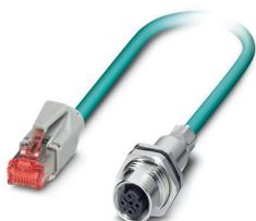
Connecteur d'appareil face arrière, Ethernet CAT5 (100 Mbit/s), 4-pôles, PUR, bleu lagon RAL 5021, Connecteur femelle encastrable droit M12 SPEEDCONNEC / IP67, sur connecteur mâle droit RJ45 / IP20, longueur de câble: 0,25 m
